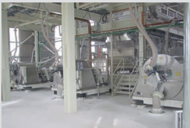
Example of installation horizontal peeler centrifuge type ProCent P 125 B XXL Installationsbeispiel / Horizontalschälzentrifuge Typ ProCent P 125 B XXL
